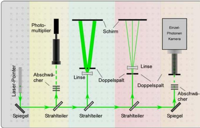
*Photonen hören:* Der Lichtstrahl wird so stark abgeschwächt, dass nur wenige Photonen pro Sekunde auf einen Detektor (Photomultiplier) treffen, in dem jedes Photon einen elektrischen Impuls erzeugt, der als Knackern in einem Lautsprecher hörbar gemacht wird.
