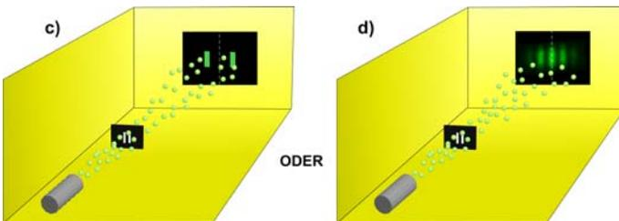
Im Demonstrationsversuch wird eine hochempfindliche Kamera, die einzelne Photonen als helle Punkte darstellen kann, eingesetzt, um das Resultat zu zeigen. Auf jedem Einzelbild der Kamera erzeugt der stark abgeschwächte Lichtstrahl etwa zehn scheinbar zufällig verteilte helle Punkte, welche die Auftreff-Orte der Photonen darstellen und so den Teilchencharakter des Lichts demonstrieren.
