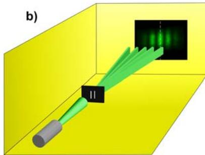
*Photonen und Wellen sehen:* Es stellt sich die von Einstein mit Bohr intensiv diskutierte Frage, was passiert, wenn man den Young'schen Versuch mit einem stark abgeschwächten Lichtstrahl durchführt, so dass in jedem Augenblick nur ein einzelnes Photon durch den Spalt fliegt. Wird man dann auf dem Schirm ein Muster sehen, das Licht-Strahlen entspricht (Abb. c), oder ein solches, das Licht-Wellen entspricht (Abb. d)?
